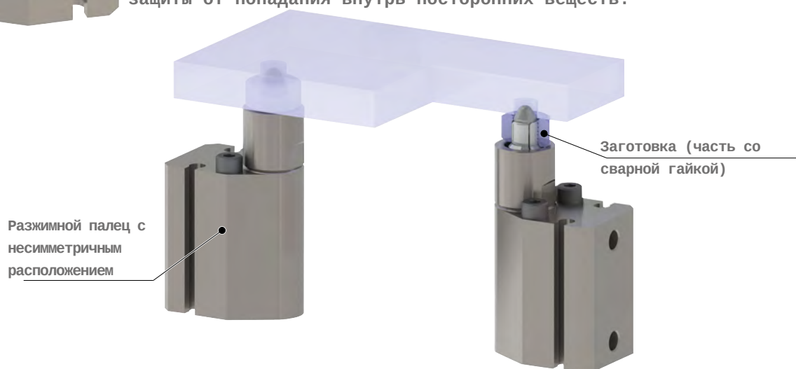
Зажимание панели со сварочной гайкой
